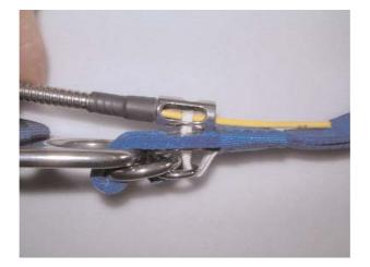
Vue finale de la gaine de libération installée sur le système 3 anneaux. Final setting of the breakaway housing on the 3 ring release system.
