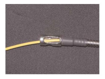
Passage de la boucle dans l'oeillet de l'élévateur. View of the cable running into the housing and the terminal end.
