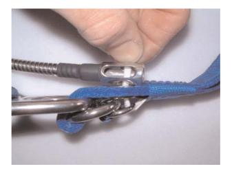
Insérer le cable dans la boucle et rangez le. Le montage doit être comme sur cette photo. Fit the cable through the white loop and stow the remaining cable. Assembly must be done like on this photo.
